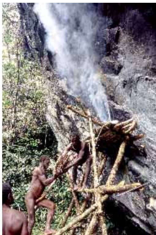
Fig. 3. Explotación de un frente de cantera mediante la acción del fuego (choque térmico). Yeleme/Wang-Kob-Me (Kp. Paniai), grupo wano.
